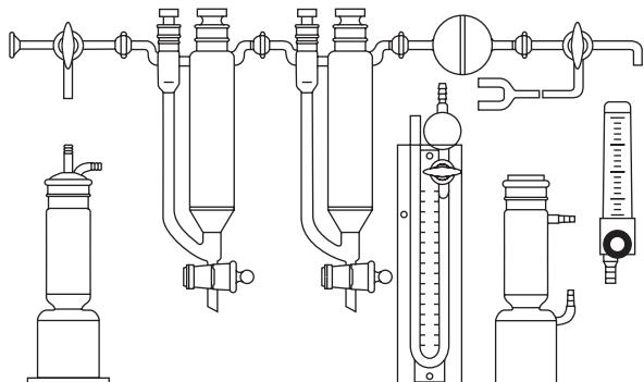
●ふつ素専用のガス吸引管とスプリング付保護管(ボール付)の形状
