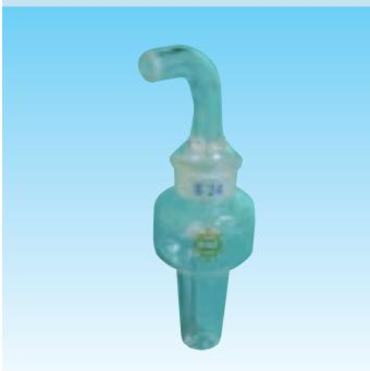
インパクタ付10mL型 ダスト捕集器と吸引ノズル
